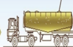
ENSILADO DEL MORTERO SECO EN OBRA DE CAMIÓN CISTERNA A SILO Portable silo loading from tanker truck
