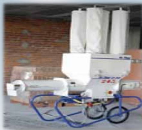
Amasadora continua de mortero Continuous wet mixer
