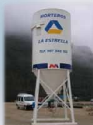
Extracción por gravedad Extraction by gravity
