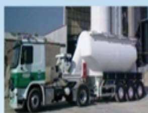
TRANSPORTE DEL MORTERO SECO EN CAMIÓN CISTERNA Tanker truck transportation
