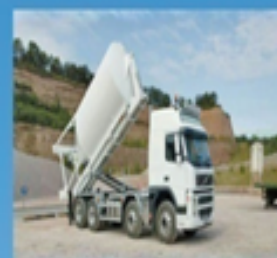
CARGA O DESCARGA DEL SILO PORTÁTIL EN LA OBRA Portable silo placement at construction site
